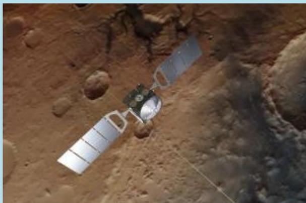
MARSIS использует низкочастотные радиоволны, способные проникать ниже поверхности планеты. А 40-метровая антенна способна улавливать сигналы, отраженные с глубины почти в пять километров. Обновление программного обеспечения предоставит улучшение качества работы приемного тракта и позволит производить достаточно сложную обработку, что увеличит качество данных, передаваемых на Землю.
