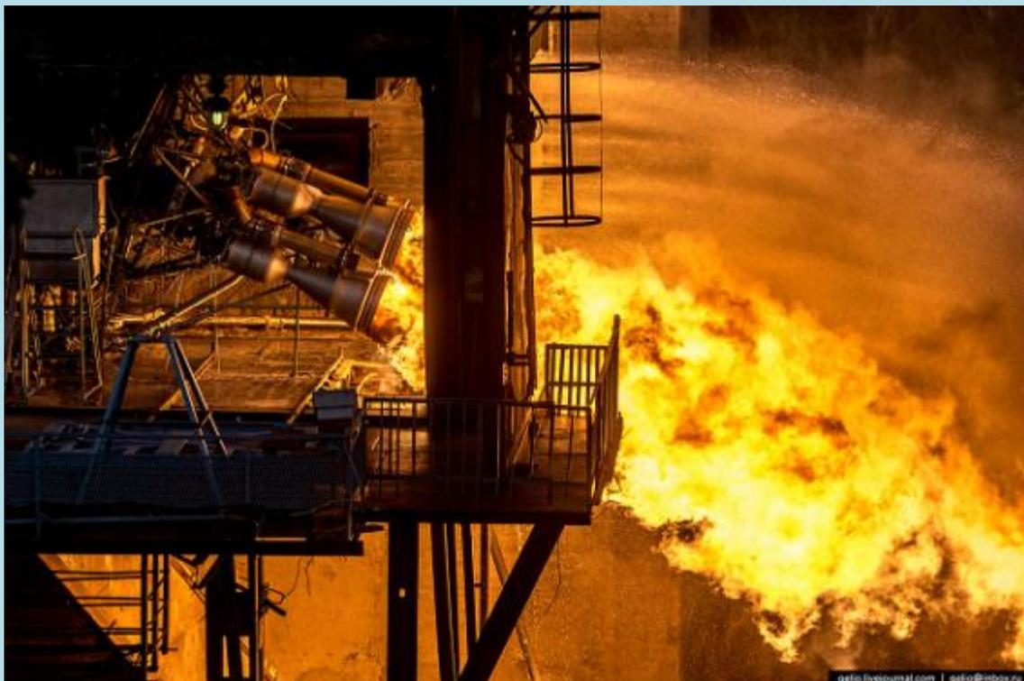
В ближайшее время НПО Энергомаш отправит в город Самара снятый с огневого стенда двигатель РД-171МВ. В Ракетно-космическом центре «Прогресс» (г. Самара, входит в Роскосмос) будет проведена сборка первой ступени ракеты-носителя «Союз-5», и двигатель пройдет еще ряд испытаний в составе первой ступени ракеты.
