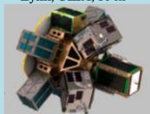
Sherpa-LTE 1, США, 150 кг, носитель для микропутников
