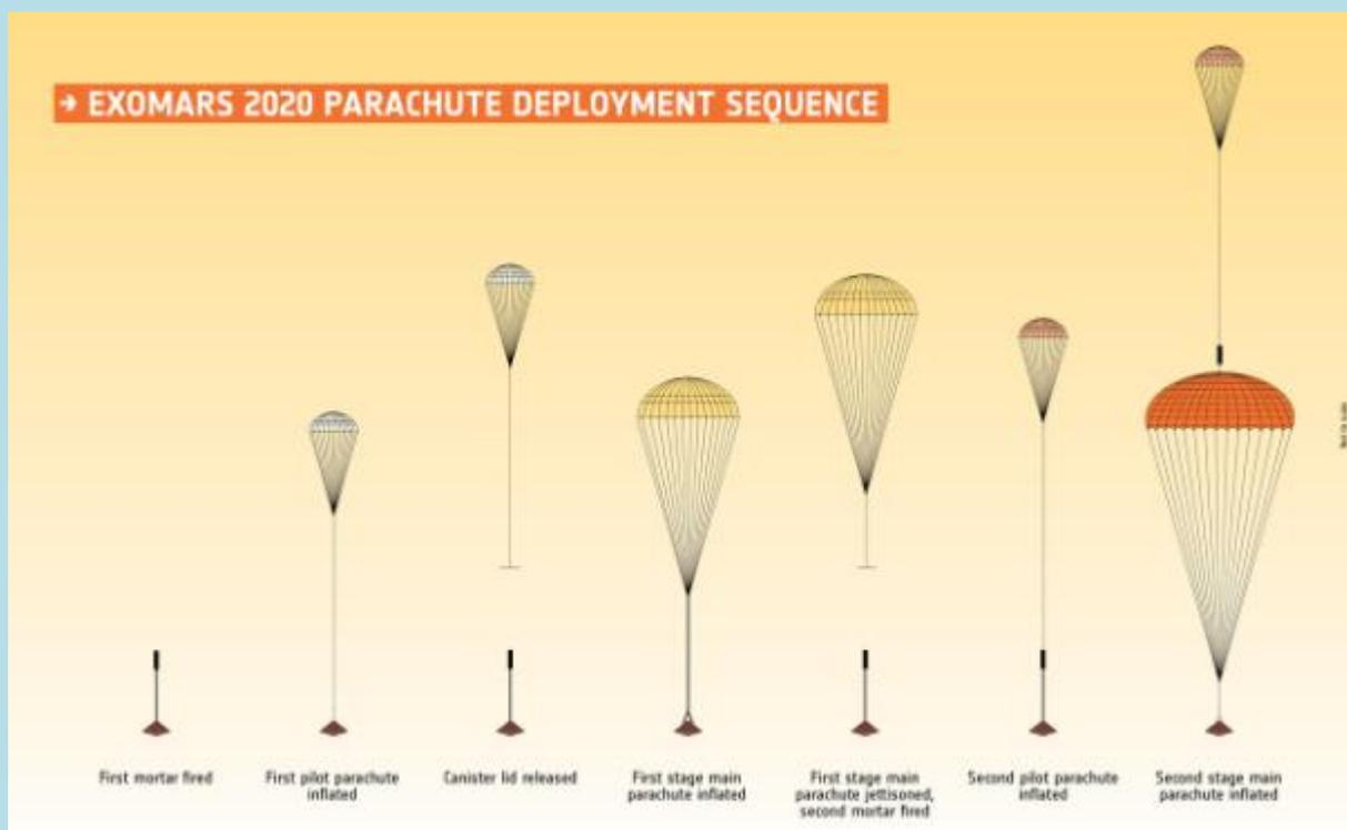
28 мая 2019 года в шведском городе Кируна были проведены очередные испытания парашютов. На этот раз тестовый аппарат был поднят на высоту 29 км при помощи стратосферного аэростата. Задачей испытаний была проверка всей последовательности работы парашютной системы.
