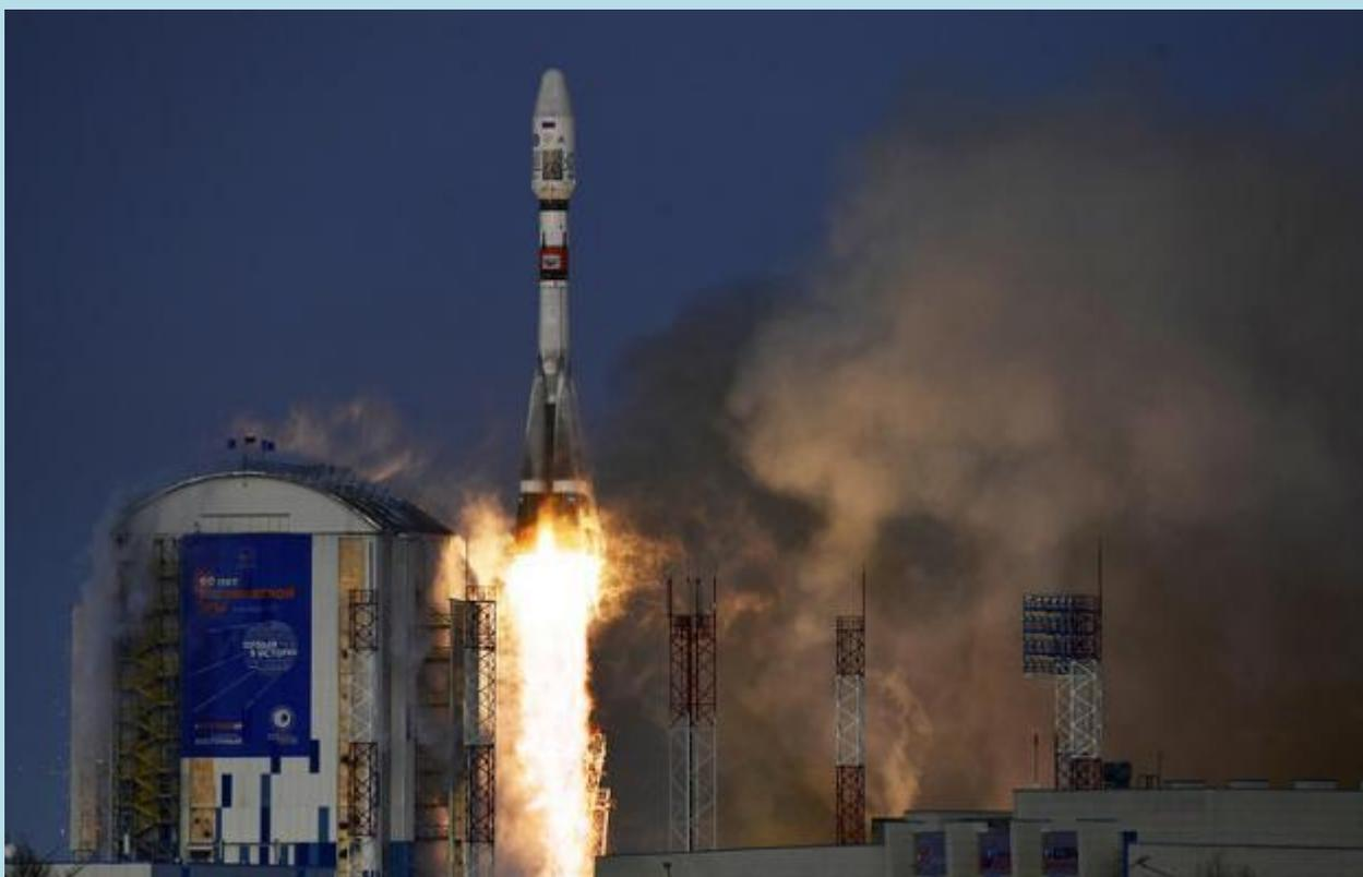
Все начальные этапы полета ракеты-носителя прошли штатно. Через 9 минут 23 секунды головной блок отделился от третьей ступени ракеты-носителя, и разгонный блок «Фрегат» начал программу выведения космических аппаратов, которая продлится более 5 часов. Путем семи включений двигательной установки разгонного блока «Фрегат» будут сформированы орбиты для отделения космических аппаратов «Метеор-М» № 2-1, IDEA, «Бауманец-2», группы КА SEAM, AISSat и LEO Vantage на высоте от 600 до 1000 км. По
