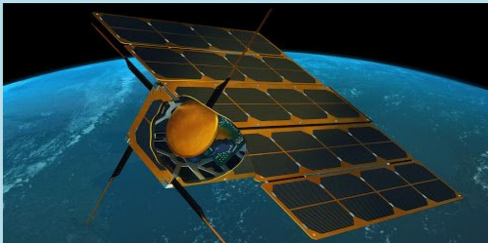
Несмотря на столь малую силу тяги, ее, этой силы, будет достаточно для того, чтобы удерживать спутник на низкой околоземной орбите на высоте 240 километров в течение шести месяцев. Для сравнения, обычные спутники CubeSat такого размера и не имеющие двигателя могут находиться на такой орбите максимум на протяжении шести недель. Помимо поддержания высоты, двигательная установка "Cannae thruster" будет использоваться для изменения высоты орбиты и траектории полета.
