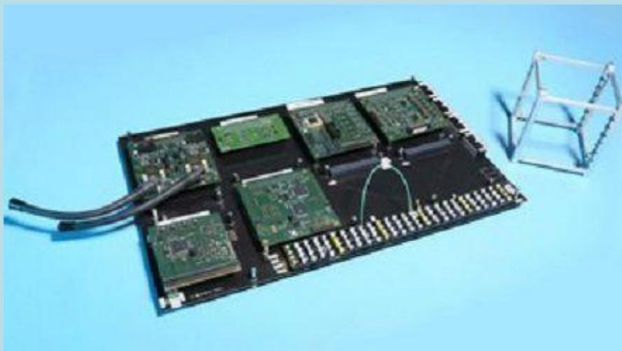
В настоящее время прототип находится в стадии "flat sat" (плоский спутник): для того, чтобы проверить работу всех его электронных компонентов, их соединили друг с другом в том же порядке, как они будут соединены в готовом спутнике, с той разницей, что сейчас они просто лежат на лабораторном столе.
