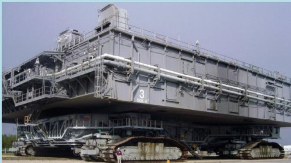
По завершению модернизации грузоподъемность транспортера СТ-2 увеличится с 5.45 миллионов до 8.16 миллионов килограмм. Это позволит транспортеру СТ-2 успешно справляться с перевозкой не только ракет-носителей SLS с космическими кораблями Orion, но и перевозить цельные мобильные пусковые установки с установленными на них ракетами меньшего класса.
