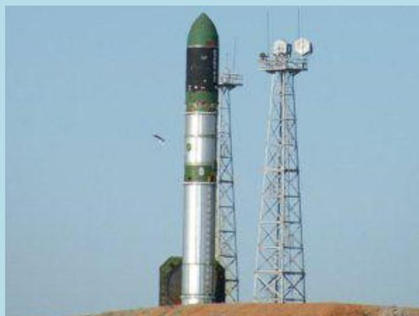
Ракета «Днепр» имеет 3 ступени. Запуск первой ступени происходит через 9 секунд после отрыва, на 112-й секунде она отделяется, через секунду запускается 2-я ступень и на 284 секунде отделяется, на 279-й произошёл сброс обтекателя. На 289-й запускается последняя ступень и работает 625
