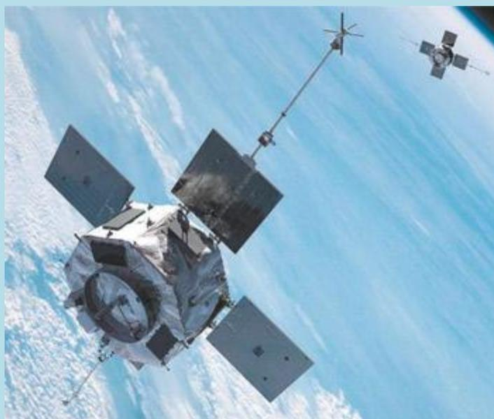
Запущенные с мыса Канаверал зонды RBSP (Radiation Belt Storm Probes) благополучно отделились от разгонного блока Centaur (Probe-A в 09:24:30 UTC, Probe-B в 09:36:38 UTC) и вышли на околоземную орбиту. Аппараты будут летать по практически одинаковым орбитам - расхождение по высоте апогея (около 30 тысяч км) будет составлять около 100 км. Зонды предназначены для изучения радиационных поясов Земли.
