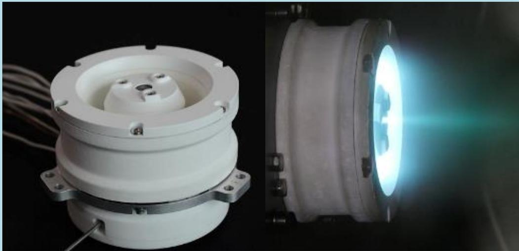
Системы тяги EchoTerra на микроспутниках Aces включают в себя двигатели Halo, компоненты распределения топлива и блоки обработки энергии.
