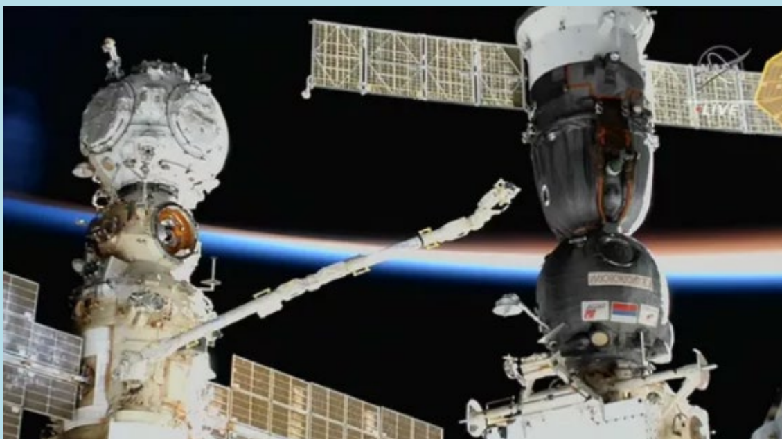
Манипулятор, управляемый космонавтом Анной Кикиной, обследует корабль Союз МС-22 после обнаружения разгерметизации системы охлаждения корабля
