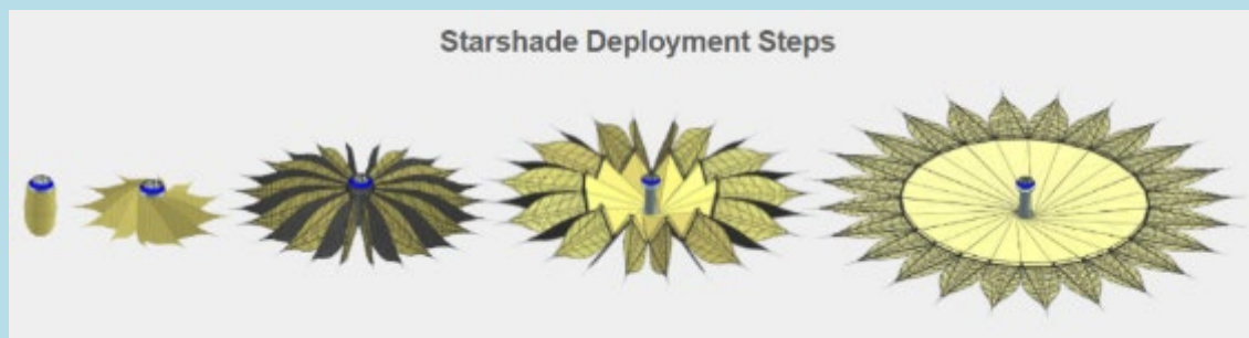
Схема раскрытия щита проекта HabEx.
