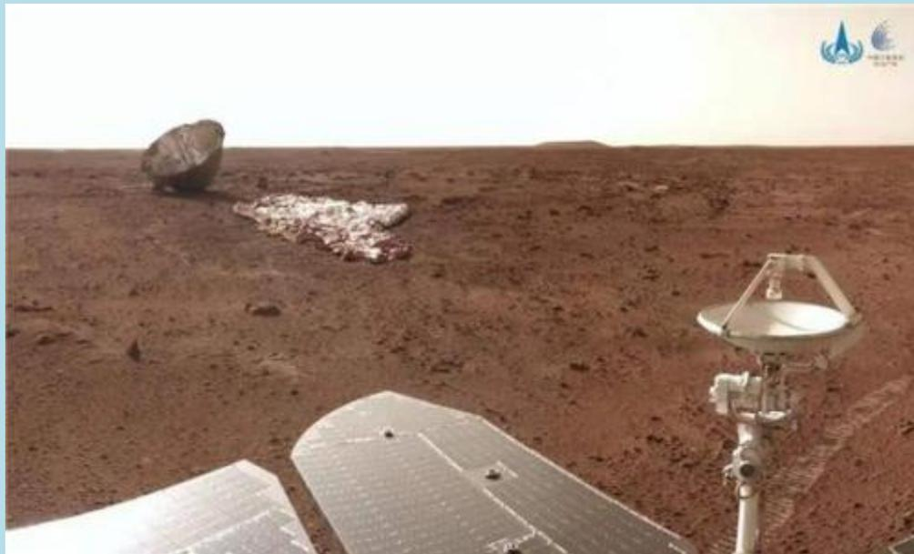
С расстояния около 30 метров Zhurong сфотографировал парашют и крышку, которые упали примерно в 350 метрах от посадки самого ровера. С помощью 34-метрового парашюта с площадью купола 200 квадратных метров посадочная платформа снизила скорость в атмосфере Марса с 2 М до 95 м/с, когда совершалась посадка 15 мая 2021 года.
