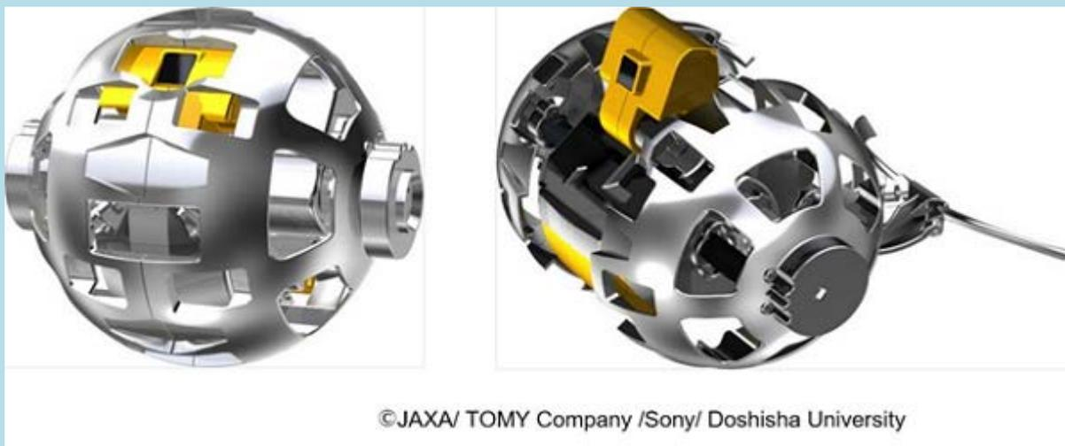
Робот создаётся с 2016 года. Весить он будет около 250 г при диаметре (до раскрытия) в 80 мм.
