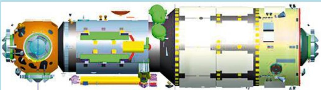
Длина основного модуля «Тяньхэ» космической станции КНР составляет 16,6 метра, максимальный диаметр - 4,2 метра, а взлётная масса - 22,5 тонны. В настоящее время этот модуль является крупнейшим космическим аппаратом, самостоятельно разработанным Китаем.
