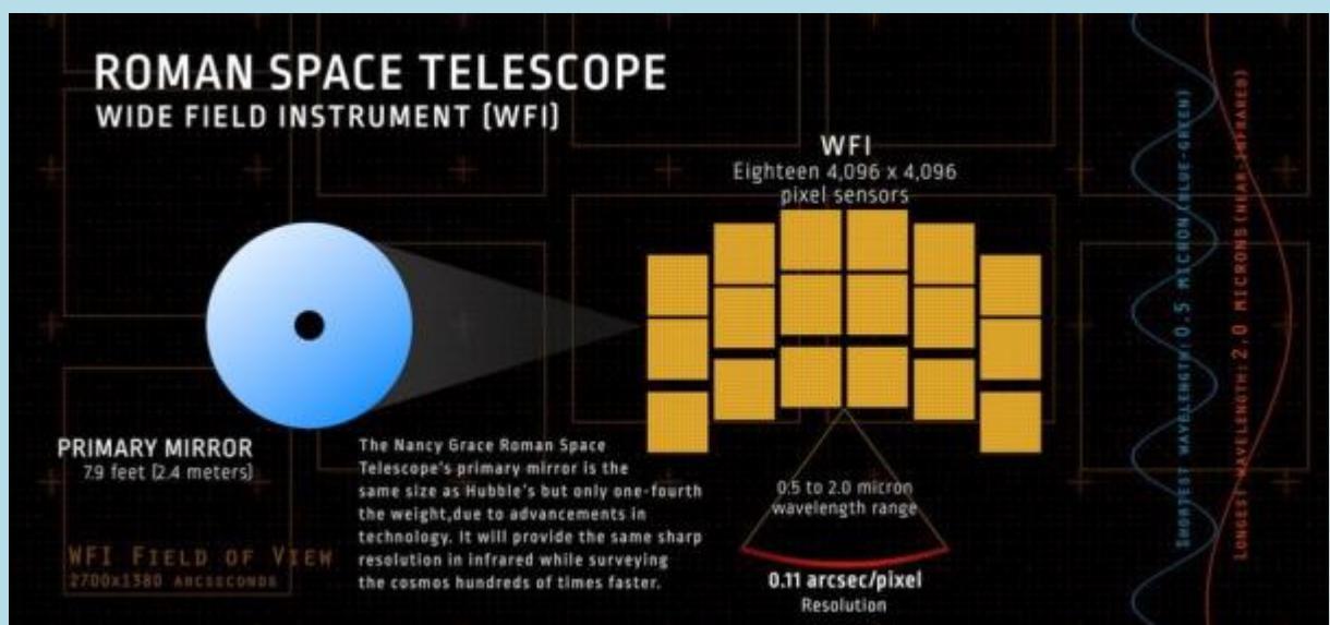
Главное зеркало и поле зрения основного научного инструмента телескопа Роман — широкоугольной камеры WFI.
