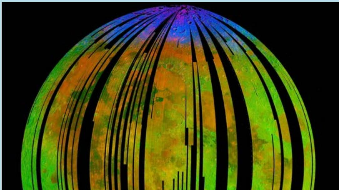
Составное изображение поверхности Луны, полученное с помощью спектрометра МЗ космического зонда Чандраян-1, показывает скопления водяного льда на полюсах Луны.
