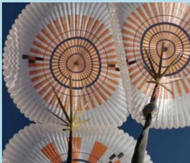
Как сообщает SpaceNews, испытания новых парашютов начались не очень гладко. Первые два сброса парашютов закончились неудачей. В ходе этих сбросов проверялась работа парашютов с превышением максимальной нагрузки. После первых неудач в конструкцию парашютов внесли изменения, и дальнейшие испытания проходили успешно.
