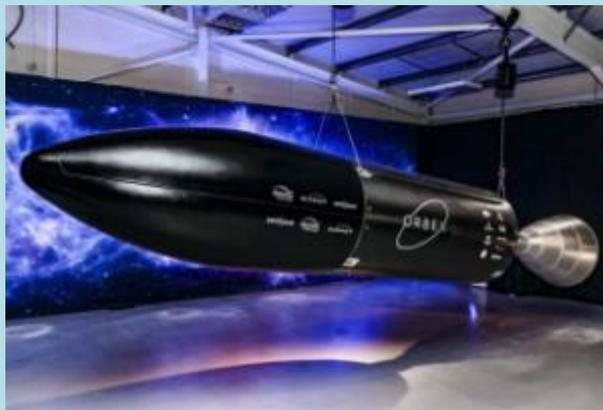
Как утверждается, технология 3D-печати позволила устранить необходимость в сварных швах — слабом месте двигателей, изготовленных традиционными способами.
