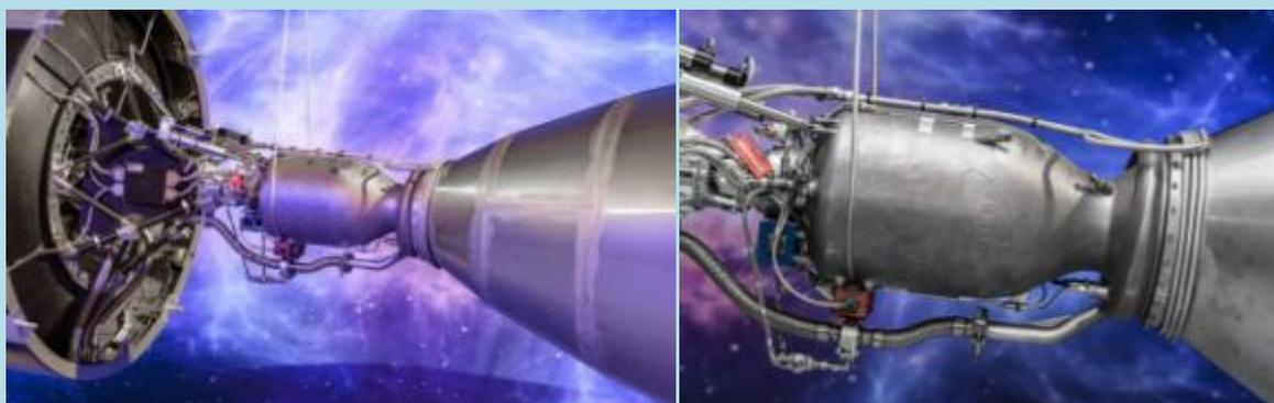
Новый реактивный двигатель работает на базе экологически чистого и возобновляемого топлива – биопропане. В перспективе это позволит уменьшить выбросы углерода в атмосферу при запусках до 90 процентов в сравнении с традиционным ракетным топливом.
