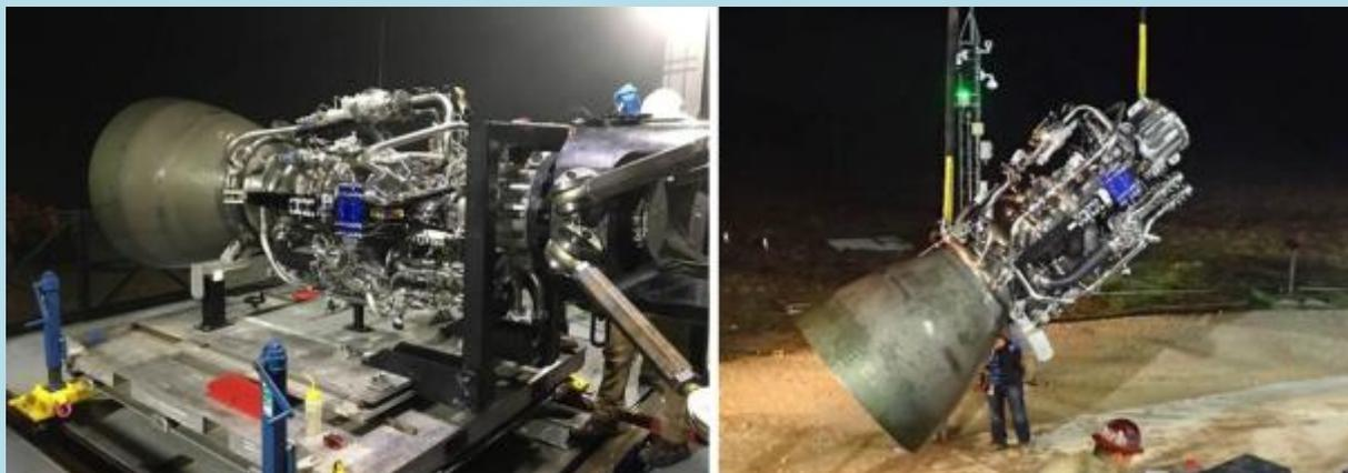
Raptor – кислородно-метановые двигатели полнопоточного закрытого цикла. SpaceX планирует достичь давления 250 атмосфер в камере сгорания. В своей первой версии Raptor будет иметь тягу 200 т. Такие двигатели будут установлены и на первой ступени системы BFR, которая называется Super Heavy, и на второй ступени (она же космический корабль) – она называется Starship. В своей первоначальной конфигурации BFR предназначена для полетов на орбиту и поверхность Луны.
