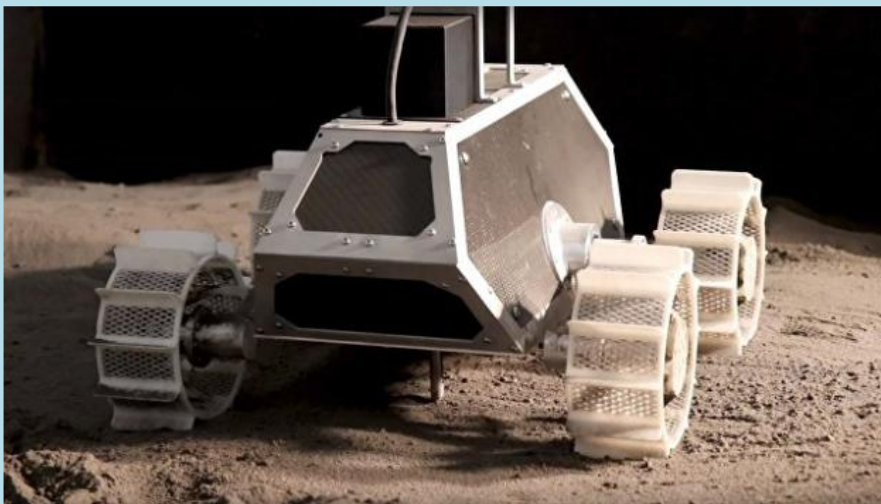
Луноход Prospector, создаваемый компанией Lunar Outpost для поиска полезных ископаемых на Луне. © Фото : Lunar Outpost
