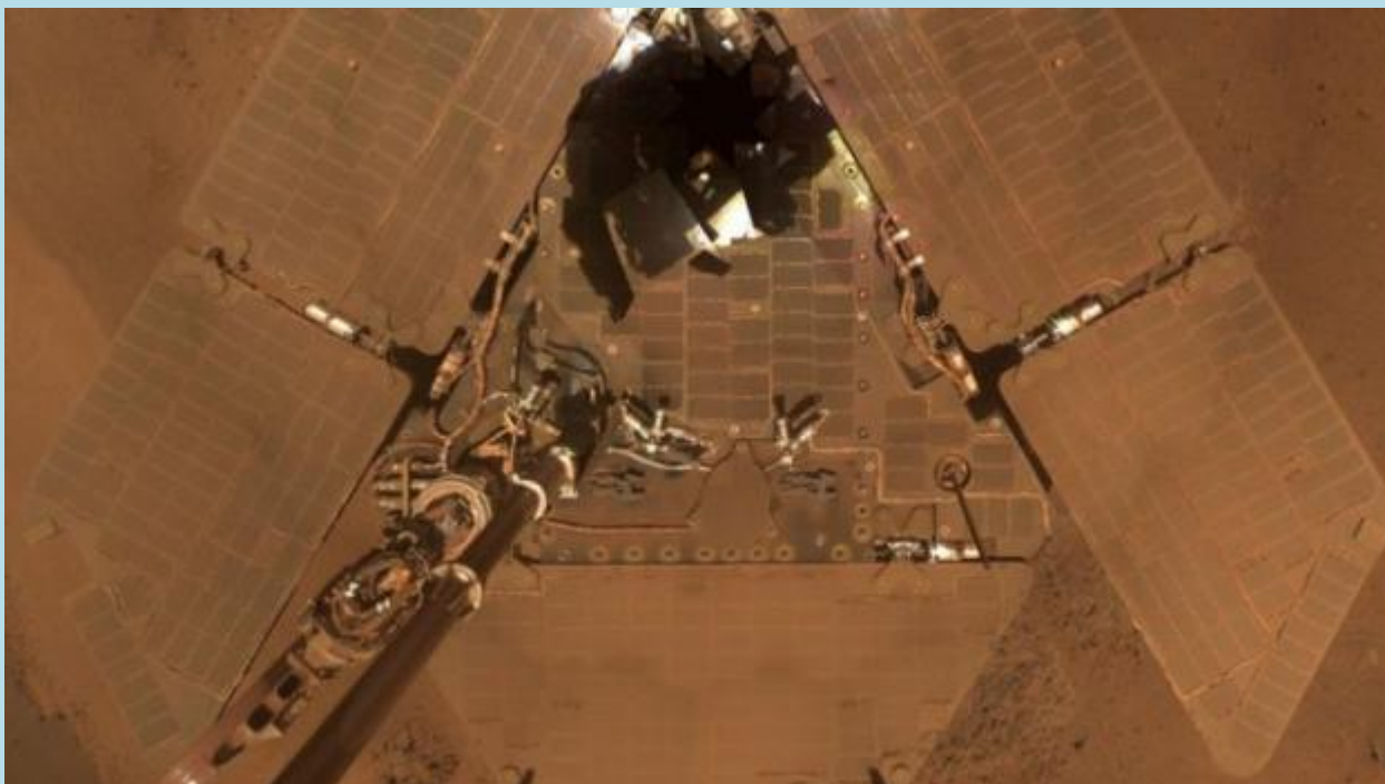
Пыль на солнечных панелях "Оппортьюнити".
