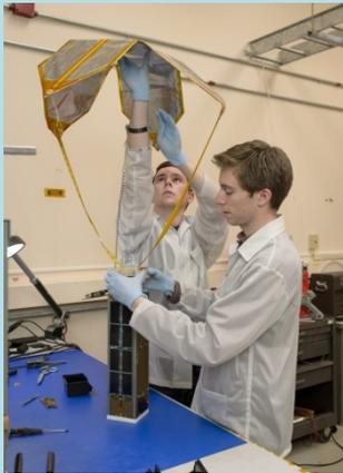
Упрощенно говоря, Echo-Brake представляет собой спутниковый парашют для компактных космических аппаратов. Он представляет конструкцию из механических распорок, гибких шнуров и системы управления. Последняя постоянно корректирует взаиморасположение элементов таким образом, чтобы увеличить сопротивление в верхние слои атмосферы и снизить скорость падения спутника. Цель проекта — создание системы, которая бы позволяла безопасно возвращать небольшие спутники в заданный район.
