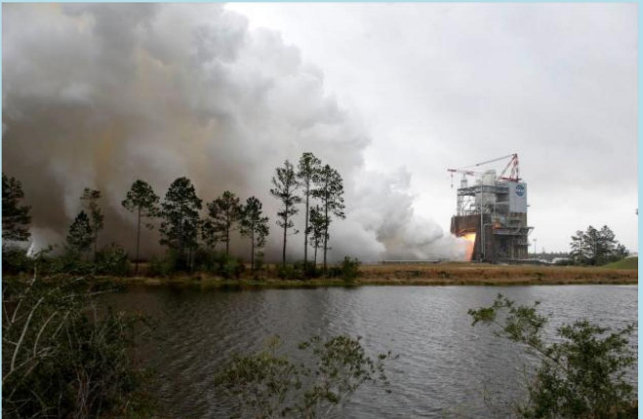
Это восьмиминутное зажигание ознаменовало первое огневое испытание двигателя RS-25, предназначенного для установки на новую ракету NASA Space Launch System (SLS), которая позволит отправлять пилотируемые миссии для исследования Солнечной системы, включая окрестности Луны и Марса. Четыре таких двигателя, ранее известные как главные двигатели космических шаттлов, будут приводить в движение центральную ступень ракеты SLS.
