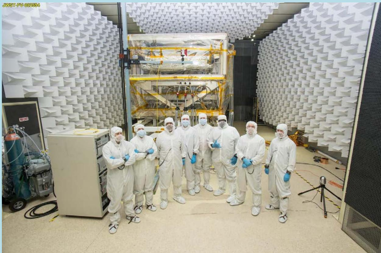
Внутри Лаборатории электромагнитных помех Центра космических полетов Годдарда НАСА, США, обстановка примерно такая же футуристичная, как в музыкальных видеоклипах американской эстрадной исполнительницы Леди Гага. Внутри этой белой комнаты, где из стен выдаются конические структуры, предназначенные для глушения отраженных радиоволн, инженеры, одетые в белые «заячьи костюмы», недавно завершили один из ключевых тестов научного инструмента под названием Integrated
