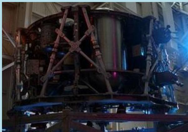
В мае-июне аппарат будет перемещен на вибрационную камеру. Этот стенд был построен специально для «Ориона». Он оснащен колебательными приводами с шестью степенями свободы по трем осям.
