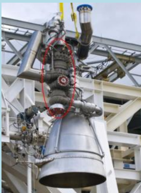
Двигатель НК-33/AJ-26. Красным выделен турбонасосный агрегат.
