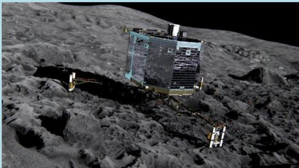
Сразу после того, как модуль Philae закрепится на поверхности кометы, он задействует все свои научные инструменты, которые начнут собирать данные, которые при помощи системы дальней космической связи аппарата Rosetta будут передаваться на Землю.
