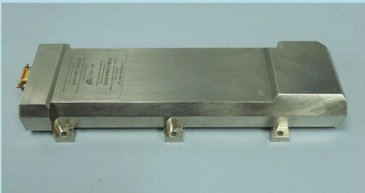
**Летный образец блока ДАН/ИНГ (импульсного генератора нейтронов) в составе прибора ДАН (с ИКИ РАН)**
