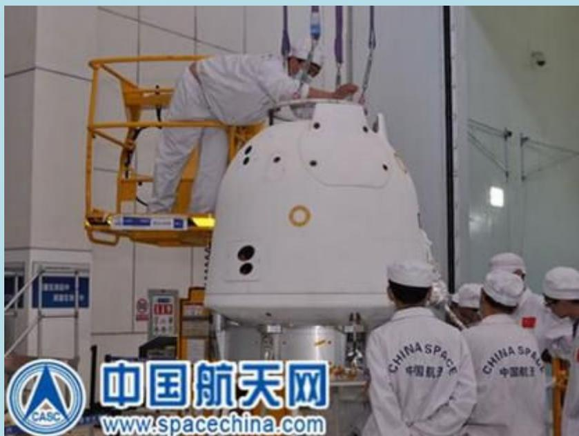
Миссия пробного орбитального аппарата включает в себя высокоскоростное возвращение в атмосферу Земли в качестве предшествующей проверки для миссии Chang'e 5. Специально разработанная капсула для возврата вернется из окрестностей Луны в атмосферу Земли, примет тепловые нагрузки, а затем приземлится.
