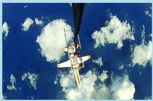
Компания Airbus стала еще на один шаг ближе к реализации своих планов относительно космического туризма и суборбитальных космических полетов. Этим шагом стали испытания прототипа будущего космического самолета SpacePlane, которые были проведены над акваторией Южно-Китайского моря. Во время этих испытаний были проведены измерения динамических условий полета, которые возникнут в завершающей фазе всего полета в целом, при возвращении летательного аппарата в атмосферу из космоса.
