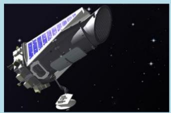
В июле 2012 года сломался первый из четырёх двигателей-маховиков гиростабилизированной платформы, которые используются телескопом для того, чтобы сфокусироваться на целевых звездах. Менее чем через год аналогичная участь постигла ещё один двигатель. Данная ситуация была критична; возникло мнение, что миссию нужно прекратить.
