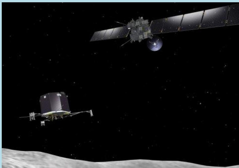
Если миссия аппарата Rosetta пойдет без сбоев и согласно намеченному графику, то 11 ноября 2014 года аппарат запустит 100-килограммовый зонд Philae в сторону ядра кометы. Приземлившись на поверхность ядра в выбранной заранее точке, зонд Philae закрепится на поверхности при помощи гарпунов и ледяных буров. После этого он сделает серию панорамных снимков, пробурит ядро кометы на некоторую глубину и произведет анализ состава ядра и атмосферы кометы.
