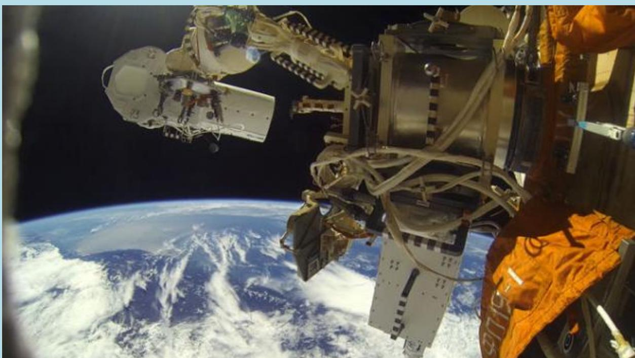
Попытка установить камеры в первый раз была предпринята в декабре. Однако наземные контроллеры не получили данных от камер, и космонавты вынуждены были демонтировать их и вернуть на борт МКС для проверки.
