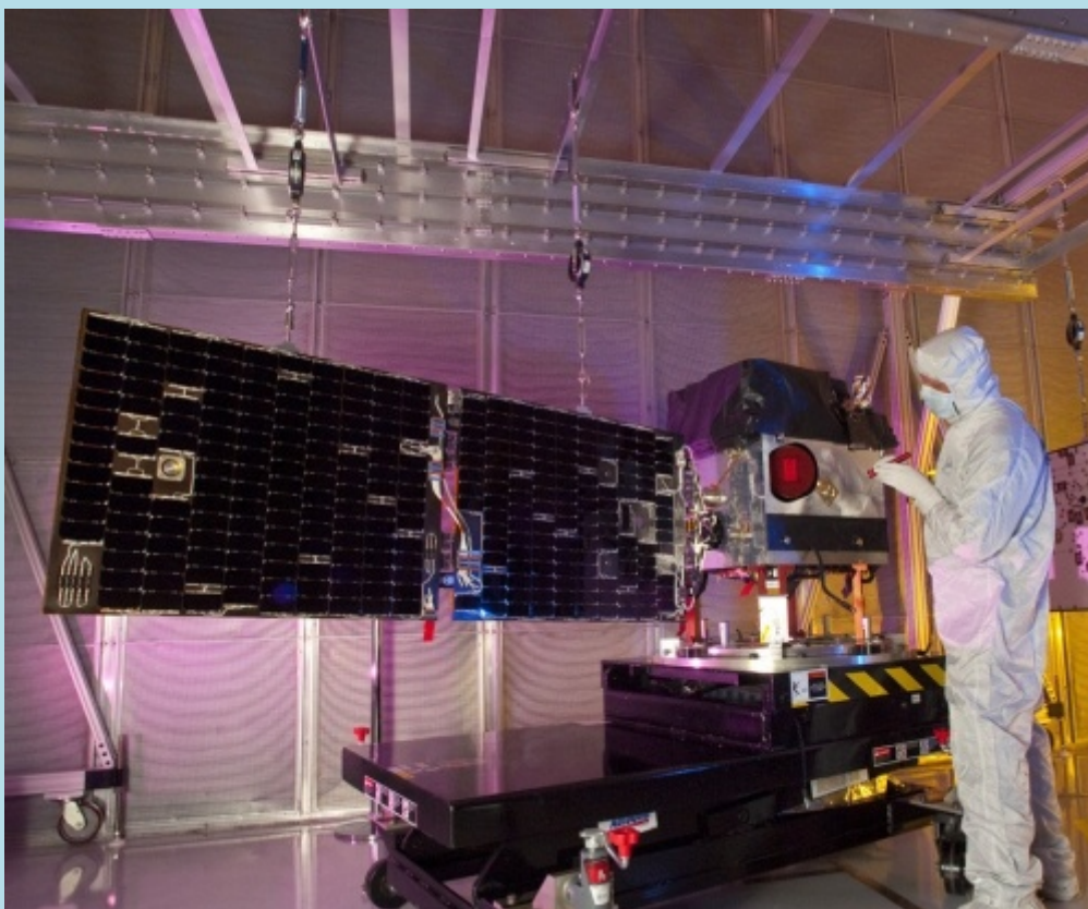
Небольшой спутник Ball Configurable Platform 100, на котором в 2015 году NASA будет отрабатывать двигатели на AF-M315E (фото Ball Aerospace).
