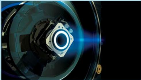
Ионный двигатель, разработанный NASA, который имеет название NEXT установил рекорд - он проработал беспрерывно на протяжении 5 лет. Двигатель обладает мощностью в семь киловатт и предназначен для установки в космические зонды.
