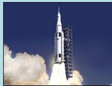
Первый испытательный запуск новой ракеты-носителя состоится в 2017 году с 70-тонной полезной нагрузкой, что уже станет рекордом для современных ракет. Однако в будущем двухступенчатая SLS сможет поднимать на низкую околоземную орбиту рекордные 130 тонн. Такие возможности открывают большие перспективы для освоения околоземного пространства, а главное – полетов вглубь Солнечной системы.
