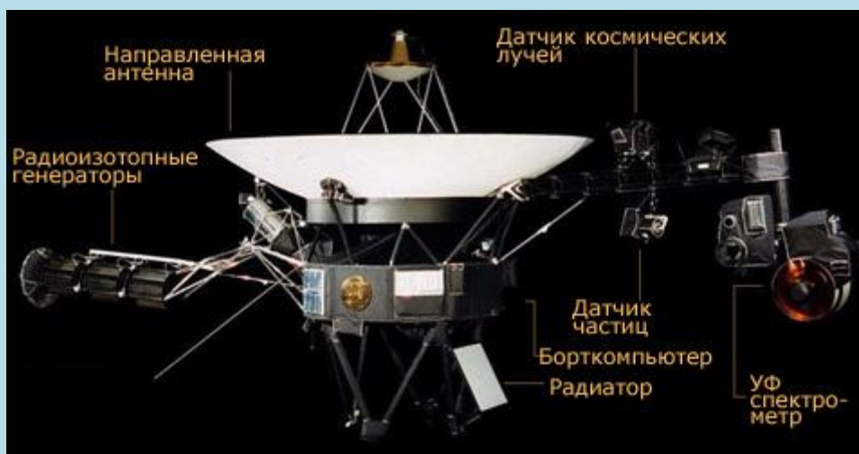
Основные узлы первого «Вояджера», оставшиеся в строю (магнитометр на рисунке не показан) (иллюстрация NASA/JPL-Caltech).
