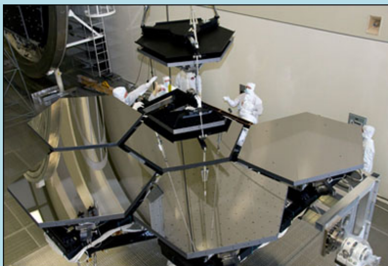
Уникальное зеркало телескопа James Webb прошло все испытания. На фото: установка зеркала в криогенной камере
