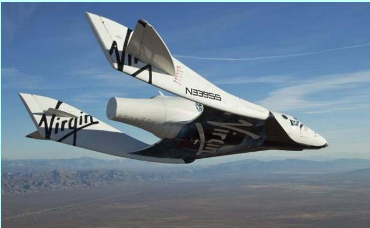
10 октября на аэродроме Мохаве, шт. Калифорния, состоялся первый испытательный полет ракетоплана Enterprise (известен также как SpaceShipTwo). Аппарат был поднят на высоту 13700 м самолетом-носителем WhiteKnightTwo, после чего отделился от него и после 15-минутного свободного полета совершил посадку на полосу RW30 аэродрома. По сообщениям информационных агентств, полет и приземление ракетоплана прошли без проблем.
