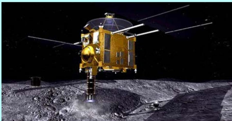
*Отказ гироскопов и сбой в системе управления, потеря части батарей, перерасход и утечка топлива, отказ узлов в ионных двигателях и эпизодическая пропажа связи – это лишь часть того, что выпало на долю зонда Hayabusa за время его семилетнего полёта. Удивительно, что японцы вообще сумели вернуть свой аппарат на Землю, пусть даже с трёхлетней задержкой против первоначального плана (иллюстрация JAXA).*
