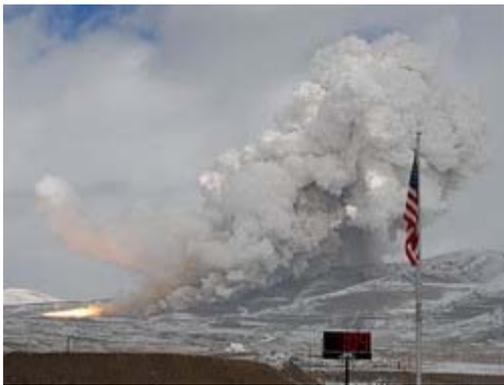
25 февраля в 18:50 UTC (21:50 мск) на испытательном полигоне Армии США в штате Юта прошло заключительное огневое испытание двигателей твердотопливных ускорителей шаттлов. Согласно официальной информации, испытание было успешным.
