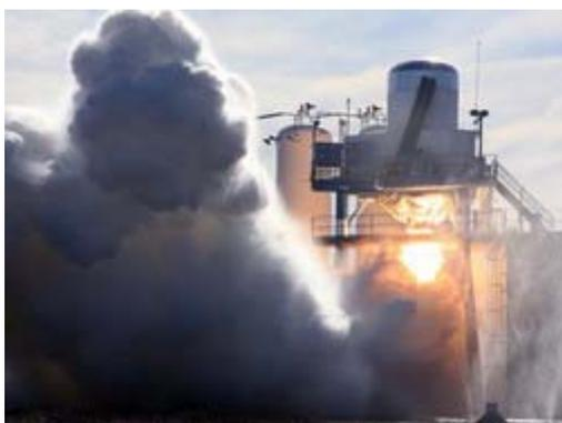
2 января с.г. на полигоне МакГрегор в штате Техас прошли огневые испытания ракетного двигателя, предназначенного для использования на 2-й ступени ракеты-носителя Falcon-9, создаваемой специалистами компании SpaceX. Двигатель проработал в течение 5,5 минут, как и было запланировано.
