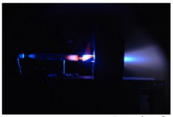
Ученые ИЗ Массачусетского Института Технологий разрабатывают портативные ракеты, предназначенные ДЛЯ поддержания необходимой орбиты спутникам вокруг Земли. Новый плазменный двигатель основе азота способен также удешевить процесс запуска спутников, как он работает на сравнительно дешевого газа.
