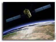
КА ОСО создан специалистами компании Orbital Sciences Corp. и предназначен для наблюдения за выбросом и поглощением углекислого газа в атмосфере Земли. - *Сайт НК*.
