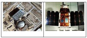
Реализация программы EROS (Earth Resources Observation System) началась с запуска 5 декабря 2000 г. спутника EROS A; 25 апреля 2006 г. был успешно запущен второй спутник программы – EROS B. Оба спутника легковесны, движутся по круговой солнечно-синхронной орбите (высота орбиты около 500 км), расчетный срок их эксплуатации составляет не менее 10 лет.
